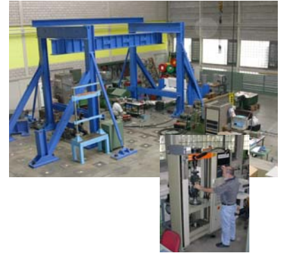
div. Universalprüfmaschinen und Prüffeld mit 100 m 3 Prüfvolumen
