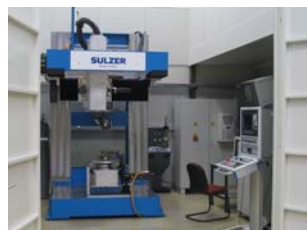
1.5 kW Faser-Laseranlage 5+2 CNC-Achsen X-Y-Z 0.5 x 0.5 x 0.7 m B,C,D,E ±180°,360°,360°,±90° mobil vor Ort einsetzbar
