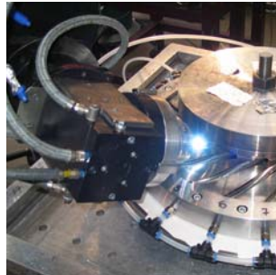
5-Achsen Tiefschweissen an einem Impellerrad
