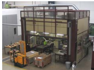
2 kW CO 2 -Laseranlage Portal-Roboter, 6 CNC-Achsen X-Y-Z 2.7 x 1.8 x 0.9 m A,B,C 360°,±90°,360° mit Konturerfassungssystem
