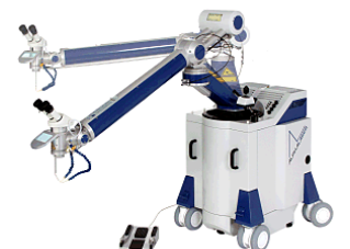
150 W Nd:YAG-Lasergerät Pulsspitzenleistung 10 kW Auslegerreichweite 1.2 m handgeführt mobil vor Ort einsetzbar
