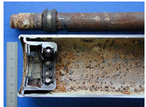
Korrosionsschaden an der Rolle eines Förderbandes
