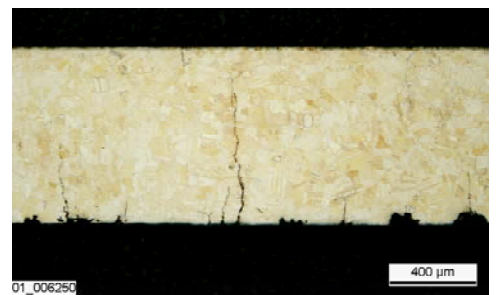
Spannungsrisskorrosion am Messingrohr eines Wärmetauschers
