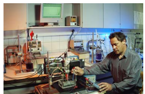
Tribo-Korrosionsprüfstand mit elektrochemischer Erfassung korrosionsrelevanter Daten
