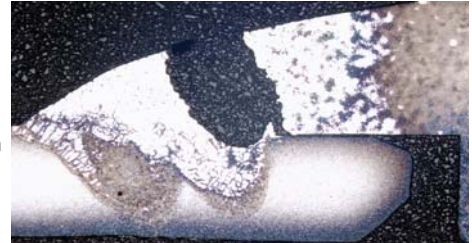
Defekte Schweissnaht in einer Hubstange
