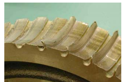
Stark verschlissenes Schneckenrad Ursache: ungeeignetes Schmieröl
