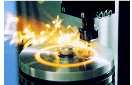
Pin-on-Disc Prüfung nicht-optimierter Werkstoffpaarung
