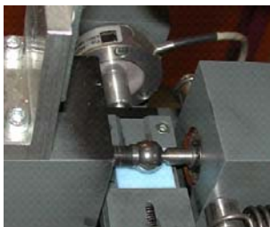
Kunststoffverschleissprüfung: PE gegen Stahlkugel
