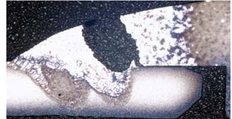
Defekte Schweissnaht in einer Hubstange
