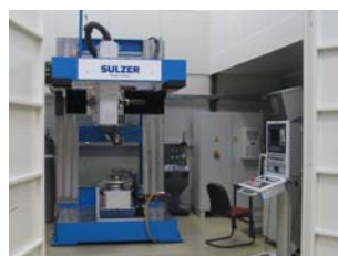
1.5 kW Faser-Laseranlage 5+2 CNC-Achsen X-Y-Z 0.5 x 0.5 x 0.7 m B,C,D,E \pm 180^\circ, 360^\circ, 360^\circ, \pm 90^\circ mobil vor Ort einsetzbar
