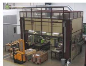
2 kW CO 2 -Laseranlage Portal-Roboter, 6 CNC-Achsen X-Y-Z 2.7 x 1.8 x 0.9 m A,B,C 360^\circ, \pm 90^\circ, 360^\circ mit Konturerfassungssystem
