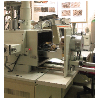
Unser Jeol JSM-IC 848A Mikroskop Die grosse Objektkammer erlaubt die Untersuchung von Proben und Bauteilen bis maximal Ø 200 x 50mm. Die Ausstattung beinhaltet ein EDX-Detektor für die Bestimmung von chemischen Zusammensetzungen.
