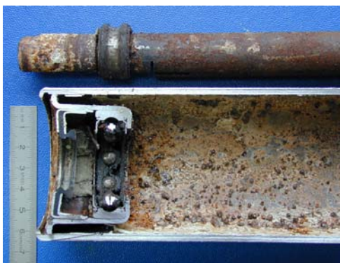
Korrosive Schädigung einer Rolle im Lagerbereich
