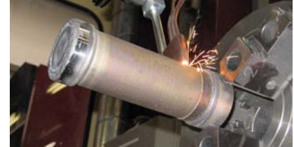
Stellite™-Beschichtung eines Ventilkörpers, 0.7 mm Dicke ausreichend aufgrund minimaler Durchmischung
