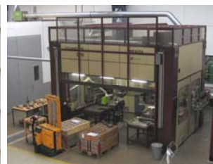
2 kW CO 2 -Laseranlage Portal-Roboter, 6 CNC-Achsen X-Y-Z 2.7 x 1.8 x 0.9 m A,B,C 360°,±90°,360° mit Konturerfassungssystem
