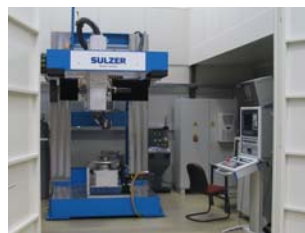
1.5 kW Faser-Laseranlage 5+2 CNC-Achsen X-Y-Z 0.5 x 0.5 x 0.7 m B,C,D,E ±180°,360°,360°,±90° mobil vor Ort einsetzbar
