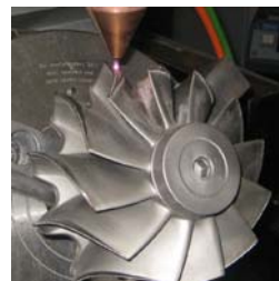
5-Achs-Auftragschweißen auf Turbolader
