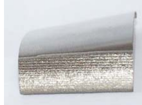
Stellite™-Beschichtung der Schaufelvorderkante gegen Tröpfchenerosion
