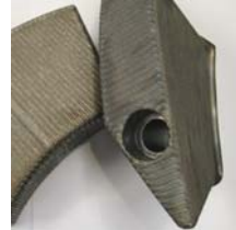
Panzerung von Knetzähnen mit WC
