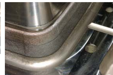
Korrektur von Untermaass auf gekrümmter Kontur, Aufbau 0.7 mm
