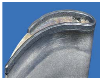
Aufschweißen der Schaufelspitze
