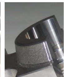
Filigranschweißung, Aufbau 0.25 mm
