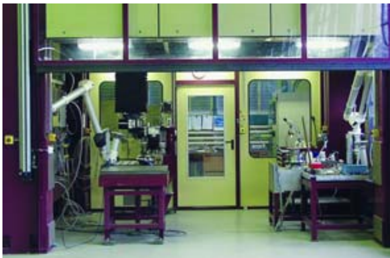
1 Die Laserschweißanlage von Sulzer Innotec besteht aus einem 2-kW-CO 2 -Laser sowie einem Sechs-Achsen-Portalroboter mit einem Arbeitsraum von 2,7 × 1,8 × 0,9 m.
